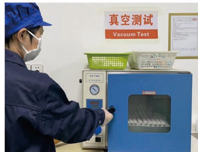
▲ 真空测试-Vacuum test
